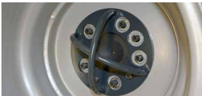
Priväzovacia konzola na náboji kola A423091
